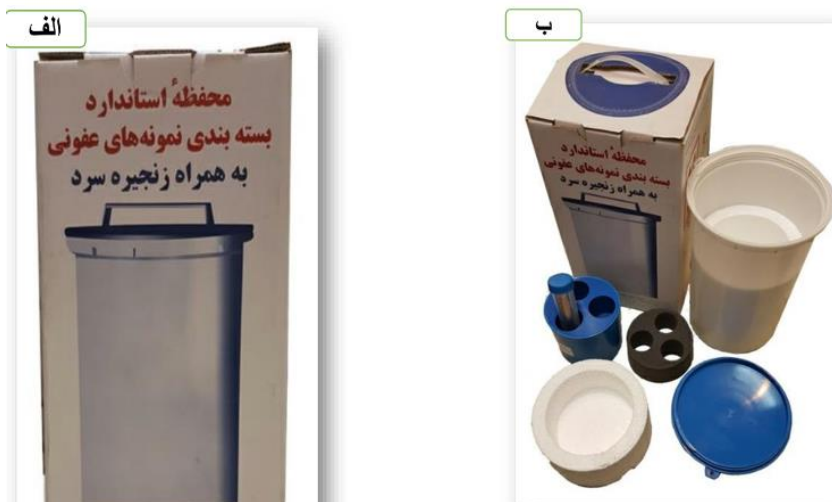
شکل ۴۴. محفظه استاندارد بسته‌بندی و ارسال نمونه‌های عفونی. (الف) نمای بیرونی، (ب) اجزای محفظه.
